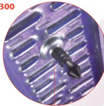
**QuickLok** - sistema de fijación sin tornillos que permite una rápida instalación y retiro de rejillas. Ayuda a reducir tiempo y costo de instalación y mantenimiento. Consta de dos seguros por metro.
