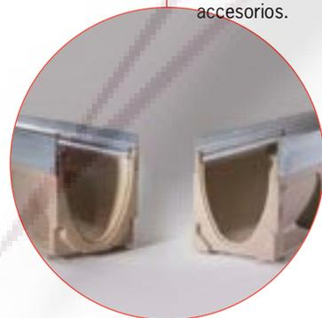
**Perfiles interconectables** permiten la unión fácil y rápida de canales. **Ranura para Sellador** - Existe una ranura de 3/16" por 5/16" en cada extremo del canal. La ranura que se crea al unir los canales permite que una línea de sellador flexible se inserte en cada unión.
