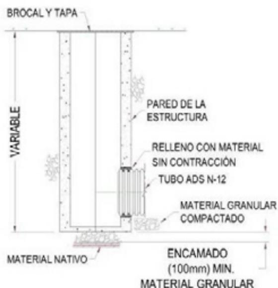
LA JUNTA ENTRE EL TUBO Y LA ESTRUCTURA DEBE CUBRIRSE CON UN MATERIAL QUE NO TENGA CONTRACCIÓN
