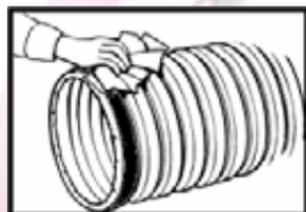
7. Evite que cualquier sección lubricada entre en contacto con el polvo. El polvo puede adherirse a la superficie y comprometer la integridad de la junta.
