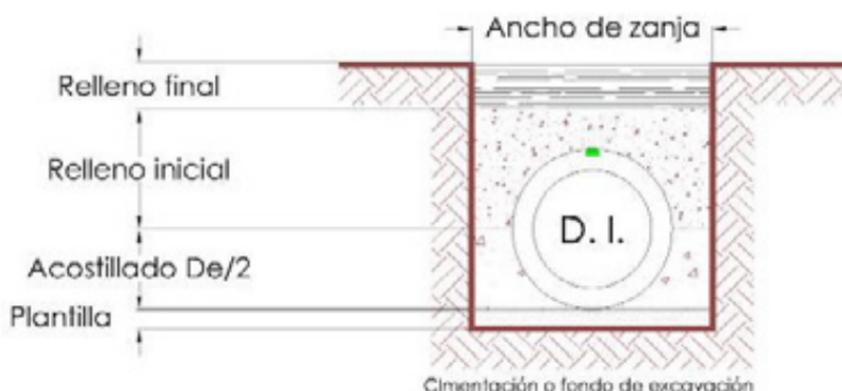
Previo a la colocación de la plantilla, debe garantizarse la estabilidad en el fondo de la excavación. Las cimentaciones inestables se pueden remplazar por material apropiado compactado en capas de 15 cm, o en su defecto considerar el uso de un geosintético como medio para reforzar el fondo de la zanja.
