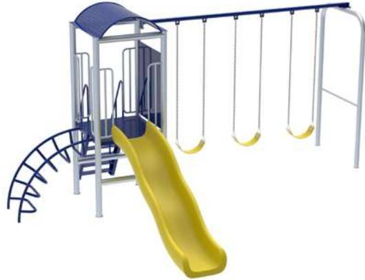
INCLUYE: Torre de acceso y resbaladilla de polietileno rotomoldeado H1.100 m, L 2.478 m (de doble pared con resistencia para parques públicos) Columpio de 3 plazas con asientos de polímero inyectados con refuerzos y con cadenas en acero galvanizado y trepador curvo
