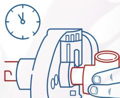
4. Mantén las piezas en los Dados del Termofusor el tiempo indicado para el diámetro de la Tubería (ver Tabla, 3 página 26).
