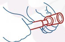
6. Inserta inmediatamente la Tubería en la conexión sin girarlos hasta que los labios se junten.
