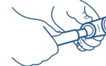
6. Inserta inmediatamente la Tubería en la conexión sin girarlos hasta que los labios se junten.
