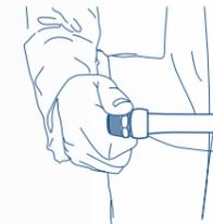
Desliza el Tubo PEX-a sobre el accesorio hasta que quede a ras con el reborde del accesorio.
