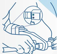
3. Verifica que la temperatura del Termofusor sea adecuada (LED verde) e inserta el Tubo y Conexión hasta la profundidad de inserción.
