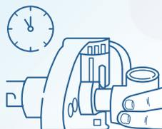
4. Mantén el Tubo y la Conexión en los Dados del Termofusor el tiempo indicado para el diámetro de la Tubería.
