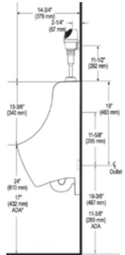
COMBOS DE MINGITORIO MEDIANO CON FLUXÓMETRO MECÁNICO DE MANIJA
