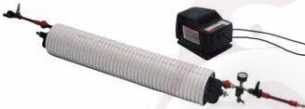
FIGURA 10.4 EQUIPO PARA PRUEBAS CON AIRE A BAJA PRESIÓN
