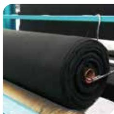
Es un Geotextil No Tejido de poliéster, conformado por un sistema de fibras, punzonado por agujas, diseñado para aplicaciones de ingeniería. Este Geotextil se produce en una de las plantas de Wavin y ha sido manufacturado bajo los controles establecidos por un sistema de control de calidad.
