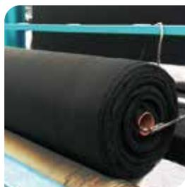
Es un Geotextil No Tejido de polipropileno, conformado por un sistema de fibras, punzonado por agujas, diseñado para aplicaciones de ingeniería (Protección de Gaviones y Geomembranas, filtros en sistemas de subdrenaje y separación de suelos).
