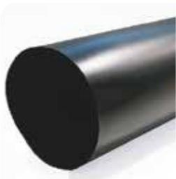
Lámina continua y flexible de HDPE lisa, utilizada como barrera impermeable de líquidos u otros fluidos en proyectos ambientales o de ingeniería civil, específicamente diseñada para condiciones expuestas a rayos UV (intemperie), se caracteriza por su alta resistencia física, gran inercia química, aislamiento eléctrico, no absorbe humedad y es inerte a agentes biológicos.
