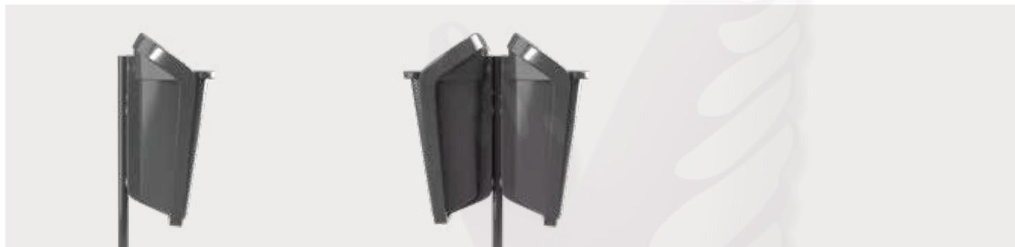
Este modelo permite su instalación en un poste o elemento de soporte existente, como farolas, señales, semáforos, etc. También es posible su instalación en su propio poste e incluso la instalación de dos unidades en el mismo poste. La instalación bien a su propio poste o elemento soporte se produce mediante flejes que unen el cuerpo de la papelera con el poste
