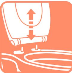
Sistema que te permite limpiar el sanitario fácilmente con solo presionar hasta sentir un clic y levantar para removerla.
