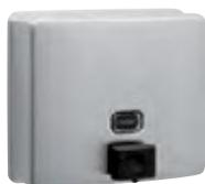
Válvula resistente a la corrosión dispensa jabones generales de uso comercial para manos. Tanque de acero inoxidable con acabado satinado. Capacidad: 1,2 L. Ventana indicadora del nivel de jabón. Sujeción oculta a la pared. Tapa abisagrada para llenado superior con llave especial para abrirla. Resistente al vandalismo.
