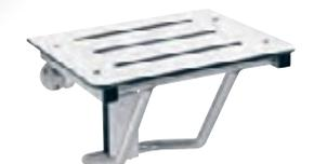
Diseño compacto. Asiento fabricado en duradera resina fenólica sólida color marfil de 8 mm de espesor y resistente al agua. La estructura y el soporte de montaje son de acero inoxidable 304 y poseen un mecanismo de bloqueo automático. Soporta hasta 204 kg cuando se lo instala correctamente.
