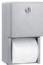
Unidad de acero inoxidable con acabado satinado y mecanismo dispensador de acero inoxidable. La puerta tiene un frente plano con cerraduras con pestillo que sobresalen. Tiene capacidad para dos rollos de hasta 133 mm de diámetro (1800 hojas de papel). El rollo de repuesto cae automáticamente en su lugar cuando el rollo de la base se acaba. Ejes antirobos de máxima resistencia.
