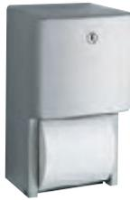
Unidad de acero inoxidable con acabado satinado y mecanismo dispensador de acero inoxidable. Cerradura con pestillo al ras. Tiene capacidad para dos rollos de hasta 133 mm de diámetro (1800 hojas de papel). El rollo de repuesto cae automáticamente en su lugar cuando el rollo de la base se acaba. Ejes antirobos de máxima resistencia.
