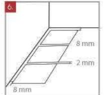
6. Aplique las especificaciones de juntas (descrito en esta guía). Dejando una junta de 2 a 3 mm como mínimo, usando separadores. No se recomienda instalar sin junta.
