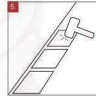
5. Asiente la pieza sobre el adhesivo, con un leve movimiento perpendicular con respecto al rayado y de pequeños golpes con el martillo de goma para evacuar restos de aire.
