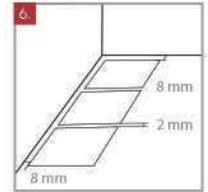
6. Aplicar las especificaciones de juntas (descrito en esta guía). Dejando una junta de 2 a 3 mm como mínimo, usando separadores. No se recomienda instalar sin junta.
