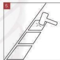
5. Asiente la pieza sobre el adhesivo, con un leve movimiento perpendicular con respecto al rayado y de pequeños golpes con el martillo de piqueta para evacuar restos de aire.
