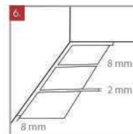
6. Aplicar las especificaciones de juntas (descrito en esta guía). Dejando una junta de 2 a 3 mm como mínimo, usando separadores. No se recomienda instalar sin junta.
