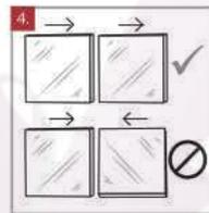
4. Coloque las piezas una a una de acuerdo al dibujo y las guías de instalación que se encuentran al reverso de cada pieza.
