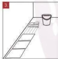
3. Aplique el adhesivo sobre el área a instalar y haga surcos con la llana dentada. Para formatos arriba de 60x60cm, se recomienda el doble encolado. Para formatos Grandes usar llana 10 a 12 mm.
