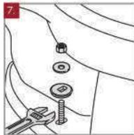
7. Instale los dos tornillos de anclaje del sanitario junto con la arandela plástica y el empuje de goma, apriételes (asegúrese de no apretarlos muy fuerte).
