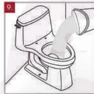
9. Descargue el contenido de un balde de agua en la taza del sanitario. Verifique que el vaciado se realiza correctamente y que no hay filtraciones de la taza.
