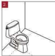
2. Ubique el sanitario sobre la boca del desagüe, verificando que coincidan a la perfección. Marque con lápiz los puntos destinados a los tornillos de sujeción. Realice un orificio en cada uno de ellos con el taladro e inserte el chazo correspondiente.
