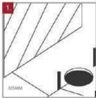
1. Limpie el área de instalación del inodoro y verifique que las distancias sean las correctas (305 mm del muro al desagüe), coloque las pijas de sujeción.
