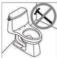
Evite golpear los sanitarios con objetos pesados o herramientas contundentes, que pueden fracturar el esmalteado o picar la cerámica.
