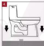
Levante la taza y lleve el sanitario hasta el sitio de instalación y asíéntelo con suavidad, sobre la salida del tubo de desagüe. Verifique que los orificios de sujeción coincidan con los chazos del piso.
