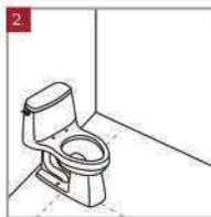
Ubique el sanitario sobre la boca del desagüe, verificando que coincidan a la perfección. Marque con lápiz los puntos destinados a los tornillos de sujeción. Realice un orificio en cada uno de ellos con el taladro e inserte el chazo correspondiente.
