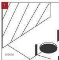
Limpie el área de instalación del inodoro y verifique que las distancias sean las correctas (305 mm del muro al desagüe), coloque las pijas de sujeción.
