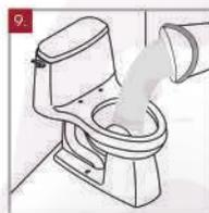
Descargue el contenido de un balde de agua en la taza del sanitario. Verifique que el vaciado se realiza correctamente y que no hay filtraciones de la taza.
