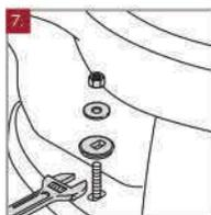
Instale los dos tornillos de anclaje del sanitario junto con la arandela plástica y el empaque de goma, apriételes (asegúrese de no apretarlos muy fuerte).
