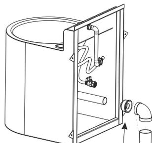
\*CONSIDERE EMPAQUE PARA CONEXIÓN DE CESPOL DE 1 1/4" Ø (NO INCLUIDO) A TUBERÍA SANITARIA DE PVC DE 2" Ø
