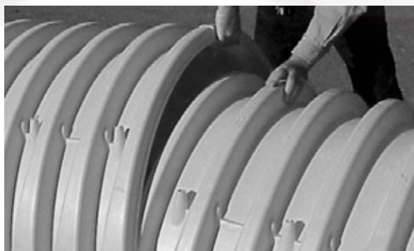
Figura 1. Empalme entre cámaras
