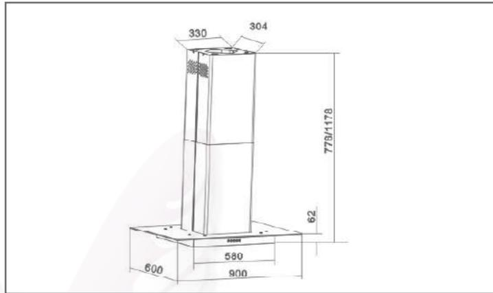
La campana purificadora/extractora para isla **EB-391**, cuenta con filtros de carbón activado que eliminan de manera eficiente los olores generados al momento de cocinar.
