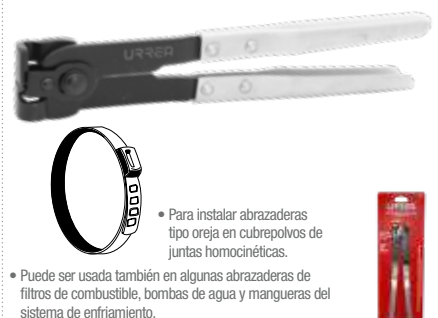
Pinza para abrazadera junta homocinética
