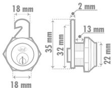
Cerrojo de acción giratoria. Cilindro de latón sólido de alta precisión con 4 pernos. Cilindro con cuerpo de 25mm.
