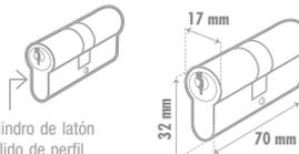
Cilindro de latón sólido de perfil europeo de 60 mm.
