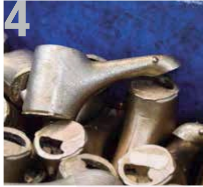
4 Extracción noyo arena Sand core pullers extraction Extraction des noyaux de sable
