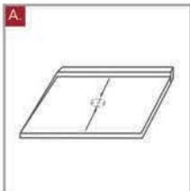
**A.** Elija la ubicación del lavabo. Asegúrese de contar con espacio suficiente debajo de la cubierta para las líneas de admisión de agua y el desagüe. Y de contar con la separación correspondiente entre pared y lavabo para la instalación de la llave.
