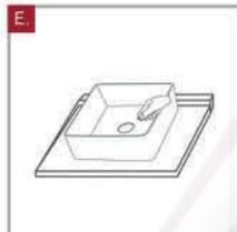
**E.** Gire el lavabo para instalarlo cuidadosamente asegurándose que queda centrado, dejando la cavidad del desagüe libre y presione firmemente hacia abajo.
