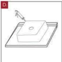
**D.** Coloque boca abajo el lavabo y aplique una cantidad generosa de silicón para muebles de baño en la parte inferior.
