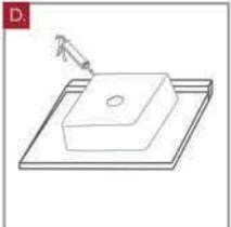
Coloque boca abajo el lavabo y aplique una cantidad generosa de silicón para muebles de baño en la parte inferior.
