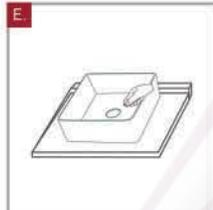
Gire el lavabo para instalarlo cuidadosamente asegurándose que queda centrado, dejando la cavidad del desagüe libre y presione firmemente hacia abajo.
