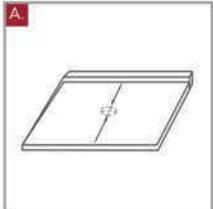
Elija la ubicación del lavabo. Asegúrese de contar con espacio suficiente debajo de la cubierta para las líneas de admisión de agua y el desagüe. Y de contar con la separación correspondiente entre pared y lavabo para la instalación de la llave.
