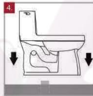
4. Levante la taza y lleve el sanitario hasta el sitio de instalación y asíéntelo con suavidad, sobre la salida del tubo de desagüe. Verifique que los orificios de sujeción coincidan con los chazos del piso.
