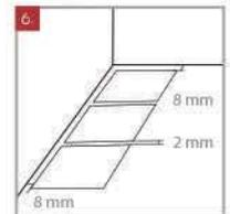
6. Aplique las especificaciones de juntas (descrito en esta guía). Dejando una junta de 2 a 3 mm como mínimo, usando separadores. No se recomienda instalar sin junta.
