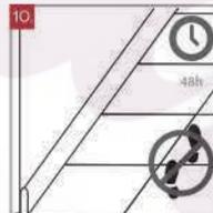
10. Una vez terminada la instalación, deje fraguar como mínimo 48 horas, no limpie, camine, ni apoye objetos sobre el material instalado en las siguientes 24 horas.
