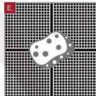
E. Retire el exceso de junteador con una esponja multiusos húmeda.
