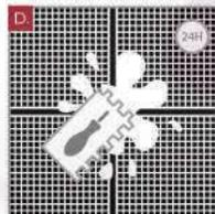
D. Espere 24 horas para que seque el adhesivo revisando que no queden residuos de adhesivo, previo a la colocación de la junta.
