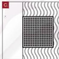
C. Recorte previamente la malla y colóquela sobre el adhesivo con 'sarcos', verificando que quede perfectamente nivelado.
