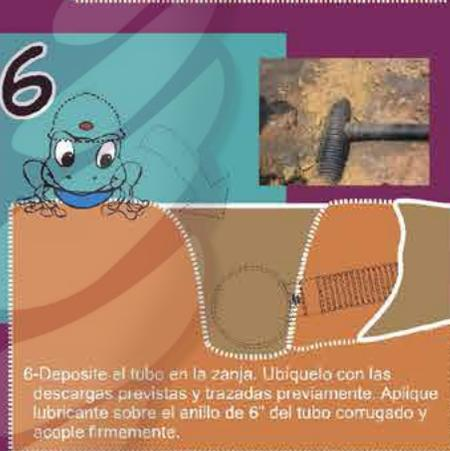
6-Deposite el tubo en la zanja. Ubíquelo con las descargas previstas y trazadas previamente. Aplique lubricante sobre el anillo de 6" del tubo corrugado y acople firmemente.
