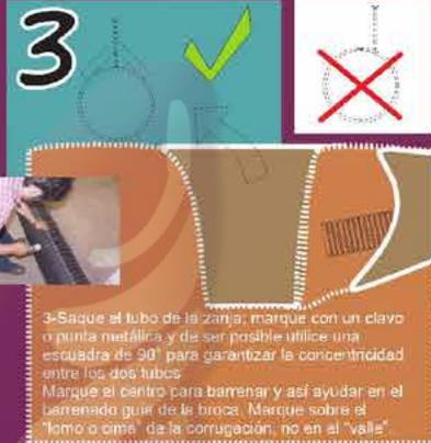
3-Saque el tubo de la zanja, marque con un clavo o punta metálica y de ser posible utilice una escuadra de 90° para garantizar la concentricidad entre los dos tubos. Marque el carlito para barrenar y así ayudar en el barrenado guíe de la broca. Marque sobre el "tomo o cime" de la corrugación, no en el "valle".
