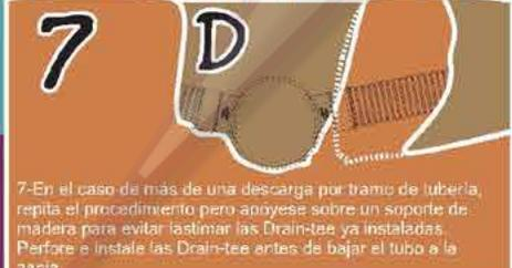
7-En el caso de más de una descarga por tramo de tubería, repita el procedimiento pero apoyese sobre un soporte de madera para evitar lastimar las Drain-tee ya instaladas. Perfore e instale las Drain-tee antes de bajar el tubo a la zanja.
