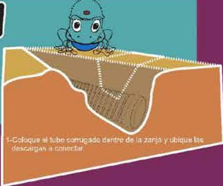
1-Coloque el tubo corrugado dentro de la zanja y ubique las descargas a conectar.
