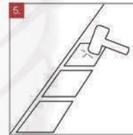
5. Asiente la pieza sobre el adhesivo, con un leve movimiento perpendicular con respecto al rayado y de pequeños golpes con el martillo de pima para evacuar restos de aire.
