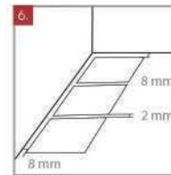
6. Aplique las especificaciones de juntas (descrito en esta guía). Dejando una junta de 2 a 3 mm como mínimo, usando separadores. No se recomienda instalar sin junta.
