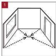
1. Asegure que la superficie a recubrir este totalmente plana, firme, nivelada y limpia.
