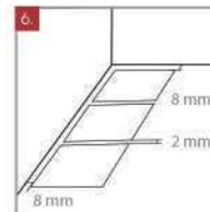
6. Aplique las especificaciones de juntas (descrito en esta guía). Dejando una junta de 2 a 3 mm como mínimo, usando separadores. No se recomienda instalar sin junta.
