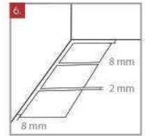
6. Aplicar las especificaciones de juntas (descrito en esta guía). Dejando una junta de 2 a 3 mm como mínimo, usando separadores. No se recomienda instalar sin junta.
