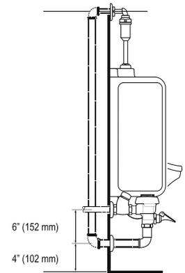
COMBOS DE MINGITORIO CON FLUXÓMETRO MECÁNICO DE MANIJA
