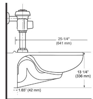
COMBOS DE W.C. CON FLUXÓMETRO MECÁNICO
