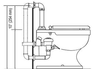
COMBOS DE W.C. CON FLUXÓMETRO MECÁNICO DE MANIJA
