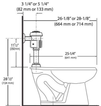
COMBOS DE W.C. CON FLUXÓMETRO MECÁNICO DE PEDAL
