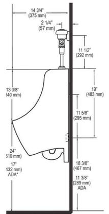
COMBOS DE MINGITORIO MEDIANO CON FLUXÓMETRO ELECTRÓNICO DE BATERÍAS
