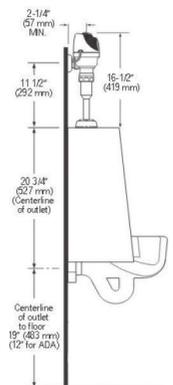
COMBO DE MINGITORIO CON FLUXÓMETRO ELECTRÓNICO DE BATERÍAS
