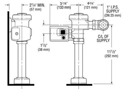
FLUXÓMETROS ELECTRÓNICOS DE BATERÍAS DE ESPECIALIDAD DE AGUA RECUPERADA PARA MINGITORIO
