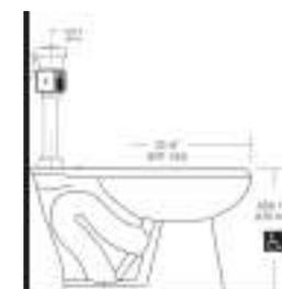
COMBOS DE W.C. ALTURA ADA CON FLUXÓMETRO MECÁNICO
