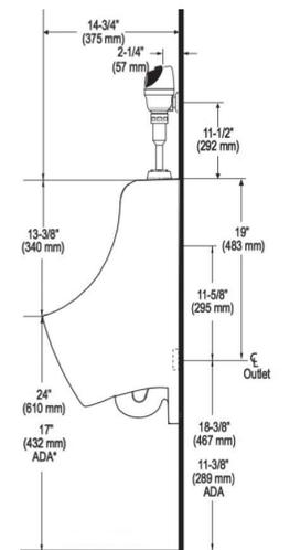
COMBOS DE MINGITORIO MEDIANO CON FLUXÓMETRO MECÁNICO DE MANIJA
