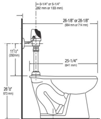
COMBOS DE W.C. CON FLUXÓMETRO ELECTRÓNICO DE BATERÍAS
