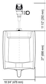
COMBOS DE MINGITORIO CON FLUXÓMETRO ELECTRÓNICO A CORRIENTE
