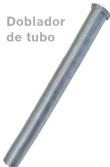
Los tubos multicapa IpeX XPA permiten combinar las propiedades de rigidez metálica del Aluminio y la flexibilidad de los Plásticos, es liviano pero rígido como los metales, lo puedes doblar con la mano y se queda de esa forma. Los flujos directos o laminares siempre se pueden obtener sin colapsamiento, el sistema IpeX XPA tiene un bajo coeficiente de expansión lineal, y es por mucho superior a tuberías de plástico alternativas, lo cual elimina la necesidad de instalación de codos.
