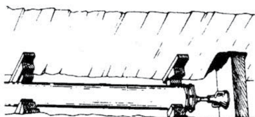
Bloque las fuerzas de empuje antes de la prueba
