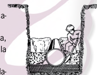
Elimine los huecos que hay debajo de la tubería
