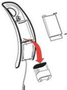
**D** Inserte una nueva Batería de Litio Tipo 2CR5 de 6 Voltios. La LED roja parpadea por un (1) minuto.
