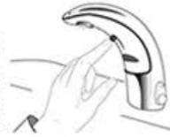
**Activación Continua** — El agua fluye constantemente de 1 a 20 minutos — para facilitar el llenado del lavabo, balde o lavado higiénico de manos. El valor prefijado de default es de dos (2) minutos de activación.
