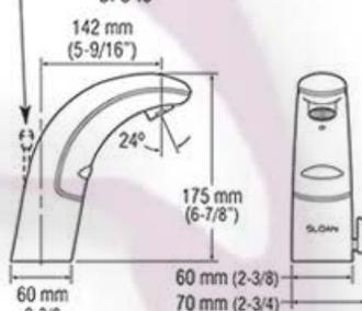
‡ Al instalar la Llave en un lavabo con tres (3) agujeros, asegúrese que el agujero central sea suficientemente grande como para alojar la espiga de la Llave. Se requiere un agujero con diámetro mínimo de 30 mm (1-3/16"). **NOTA:** Se requiere un agujero de diámetro 31 mm (1-7/32") si la cubierta tiene un grosor superior a 13 mm (1/2").
