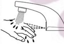
3. Cuando se retiran las manos del sensor OPTIMA®, la ausencia de luz reflejada genera una señal eléctrica que desactiva la válvula solenoide y cierra el flujo de agua. A continuación, el circuito se reinicia automáticamente y queda preparado para el siguiente usuario.
