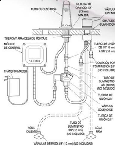
**Grifo ETF-80 con válvulas de mezclado con las variantes BDM y BDT para el suministro de agua caliente y fría (se muestra con chapa de guarnición de 101,6 mm)**
