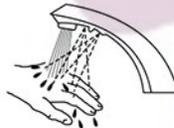
3. Cuando se retiran las manos del sensor OPTIMA®, la ausencia de luz reflejada genera una señal eléctrica que desactiva la válvula solenoide y cierra el flujo de agua. A continuación, el circuito se reinicia automáticamente y queda preparado para el siguiente usuario.
