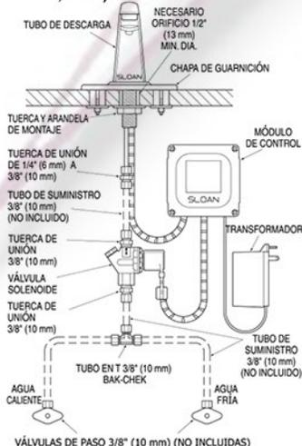
**Grifo ETF-80 con válvula de mezclado con la variante ADM para el suministro de agua caliente y fría (se muestra con chapa de guarnición de 203,2 mm)**
