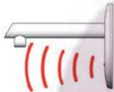
2. Cuando las manos del usuario entran en el rango efectivo del haz, el haz se refleja hacia el receptor del sensor y activa la válvula solenoide permitiendo que fluya agua templada por la llave. Fluye agua hasta que las manos se retiren o hasta que la llave alcance su límite automático de pausa.
