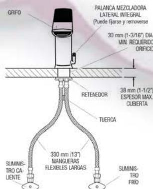
Debe utilizarse una Placa Base cuando la Llave Serie BASYS se instala en un lavabo con tres (3) perforaciones.
