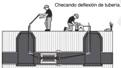
Figura 30. Prueba de paso de vía deslizando un mandril.
