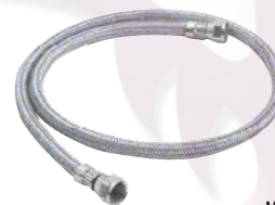
Tramado: aluminio Manguera interna: P.V.C. atóxico Tuerca e inserto: latón
