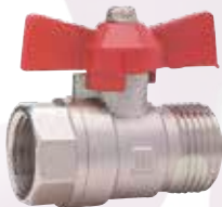
Cuerpo / material: latón Presión de trabajo: 300 lbs/pulg 2 Tipo de uso: servicio agua / aceite / gas (aire) / W.O.G. (air)
