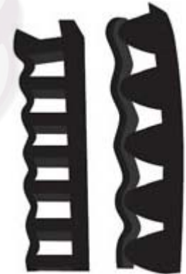
Drenes de paneles geocompuestos de núcleo abierto de parales rectos (izquierda) y cónicos (derecha)
