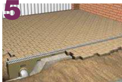
5 Coloca el pavimento al nivel requerido. La rejilla debe quedar 3 mm por debajo como mínimo.
